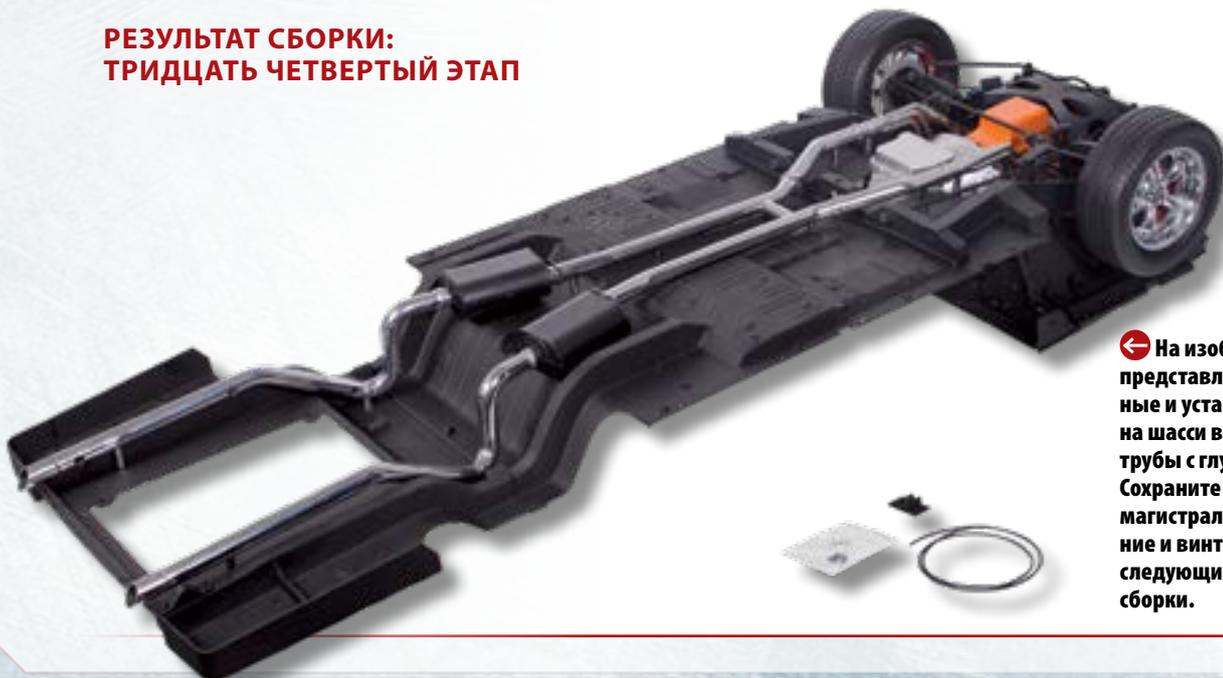
← На изображении представлены собранные и установленные на шасси выхлопные трубы с глушителями. Сохраните тормозную магистраль, ее крепление и винты SM для следующих этапов сборки.
